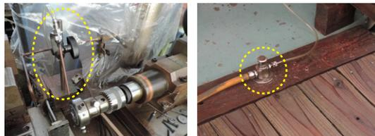
TC80を使用して専用機などの刃物へのエアブローに使用できます。
